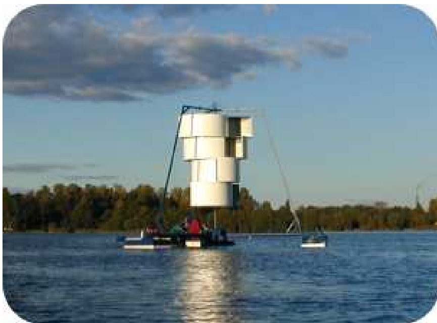
Ryc. 17. Aerator pulweryzacyjny pracujący na jeziorze Trzesiecko w Szczecinku ( http://www.aerator.pl/ )
